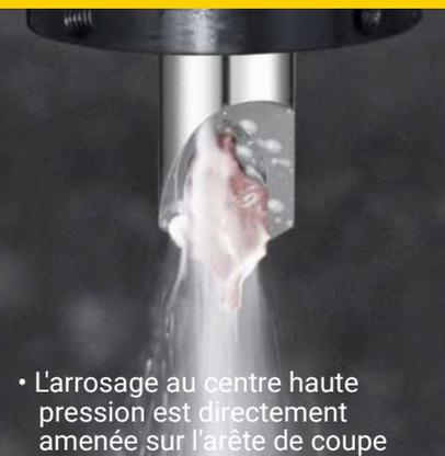
• L'arrosage au centre haute pression est directement amenée sur l'arête de coupe
